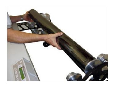
LOAD ROLLS ON THE REMAINING ROLL HOLDERS.
